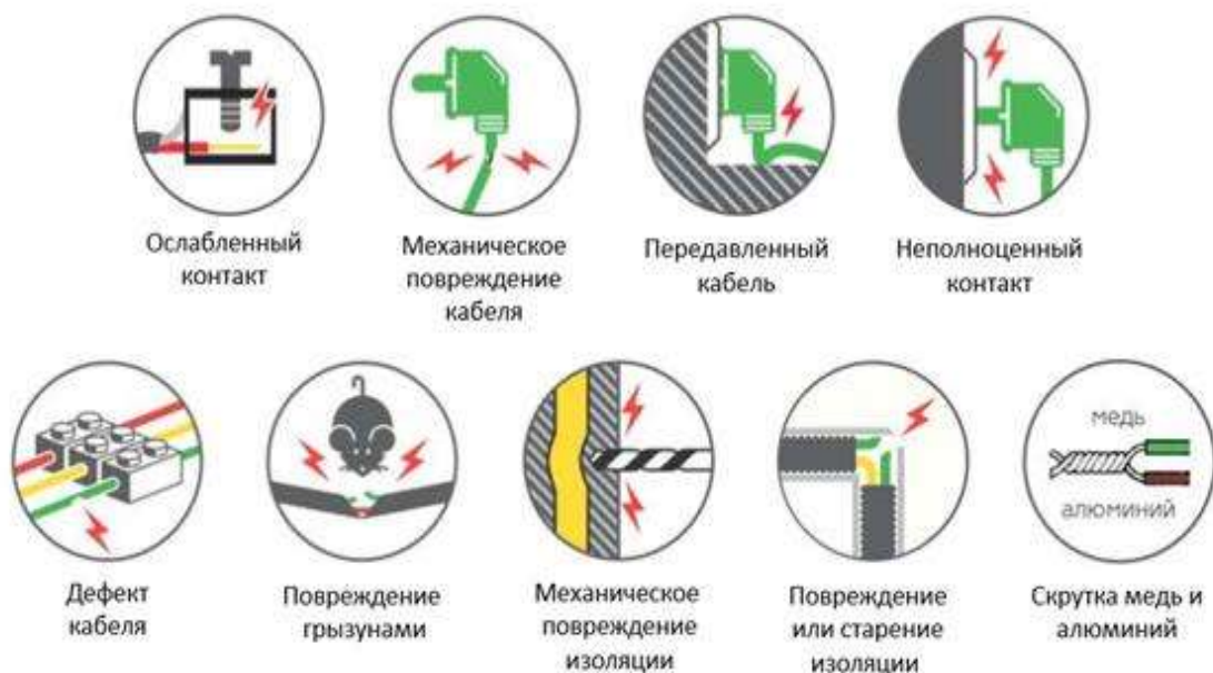
Рисунок 6. Возможные причины искрения в электропроводке
