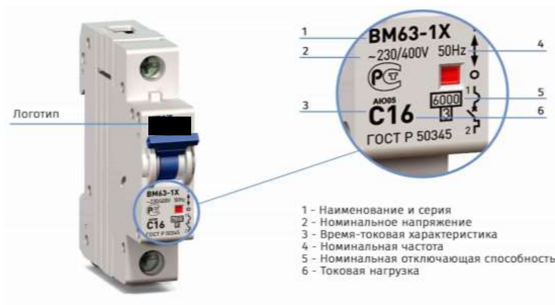
Рисунок 2. Пример маркировки АВ
